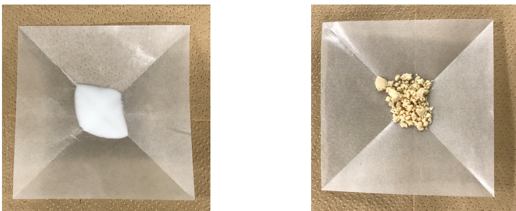
図 B.6 顕微鏡観察した呈色前後のメタルスカベンジャー。元々が左で、純化後 LAB による呈色が右である。それぞれ 1 g ずつ取り出している。呈色後のメタルスカベンジャーは LAB から分離後、濾紙に押し付けてできるだけ液を吸い取った。
