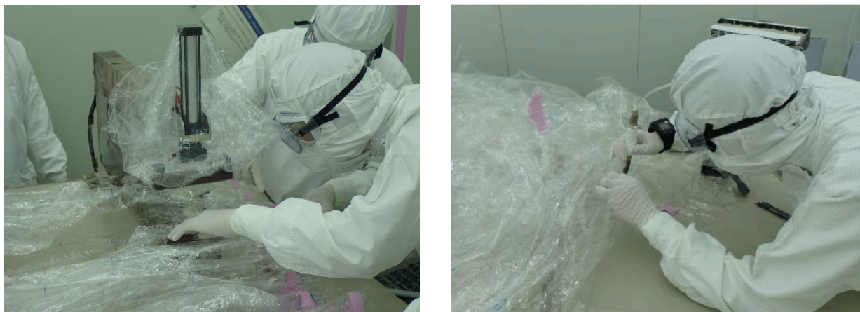
図 3.11: バルーン作成の様子。左図のように、熱溶着によりナイロンフィルムどうしを接着し、ミニバルーン作成を行った。溶着したラインからリークがないかを確認するため、ヘリウムを用いたリークチェックも行った。
