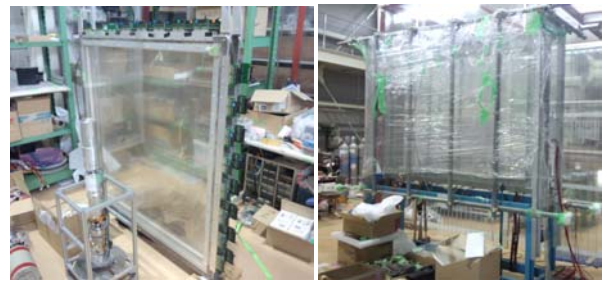
図 3 KURAMA スペクトロメータ下流部の大型 DC。KL チェンバー (左) と AIDA チェンバー (右)
