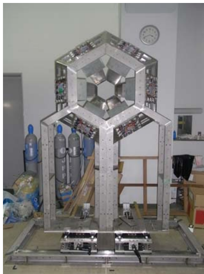
図 4 組み立てた Hyperball-X 架台、6 台のクローバー型ゲルマニウム検出器と BGO サプレッサーがインストールされる。
