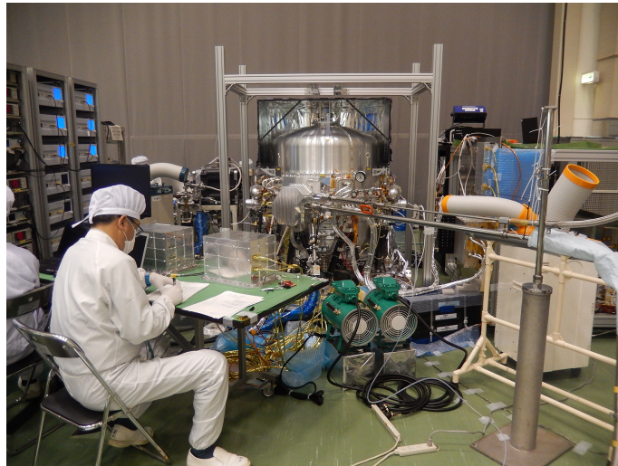
Figure 1: 本研究で耐高計数率化をはかった PSP のエンジニアリングモデルを用い，全体を組み合わせて性能確認試験を行う様子
