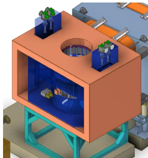
図3 ハイペロンスペクトロメータ用ヘルムホルツ型超伝導電磁石。背後に見えるのは既存の KURAMA 電磁石。
