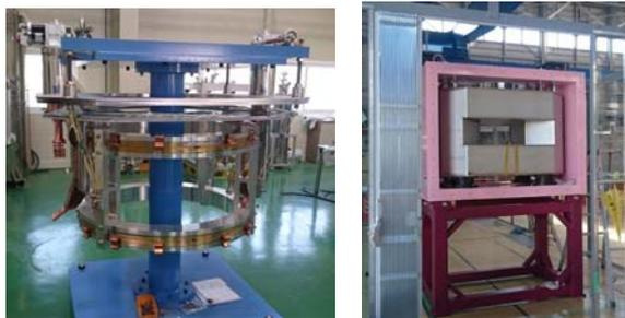
図3 (左) 製作中の超伝導コイル。(右) 納品された超伝導電磁石。
