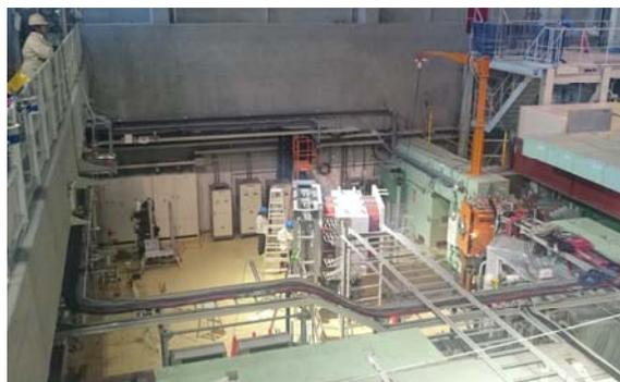
図4 K1.8 エリアに設置された KURAMA 電磁石とドリフトチェンバーDC2。
