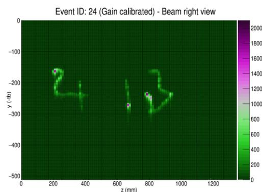
した全TPCシステムの総合テストを、宇宙線を用いて行った。TPCで得られた宇宙線の飛跡の内、非常に面白い例の2次元ヒストグラムを示す。まるで来年度4月13日に実験を行うべしというご神託のようである。スムーズなデータ読み出しが確認されたので、10月末にTPCをSAMURAI電磁石の下流に設定し、他の実験のために調整された核子当たり200 MeVの $^{79}\text{Se}$  2次ビームをAlとSn標的に照射するTPCシステムのビームコミッショニングを行い、システムが安定に動作することを確認した。右図は、このコミッショニング実験の際に得られたセミオンラインデータの一例で、多数の粒子が同時に放出される事象が明確に測定できることを示している。
