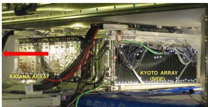
ことが期待されるが、それ以外の場合は入射原子核と同じような粒子がそのままTPCに突入し、前方方向に突き進む。正面衝突事象を選び出すため、昨年度までテスト実験をしながら開発してきた、側方に放出される多数の小さな塊を測定する計60本のシンチレーション検出器から成るKYOTO ARRAY、それに前方方向に入射粒子に似た粒子が放出される事象を排除するため、計12枚のシンチレーション検出器から成るKATANA ARRAY、の実機製作を終え、写真に示したようにTPC周りへの設置を完了した。
