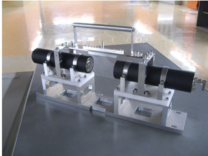
図 3.3 Plastic scintillator と光電子増倍管の写真 [7]
