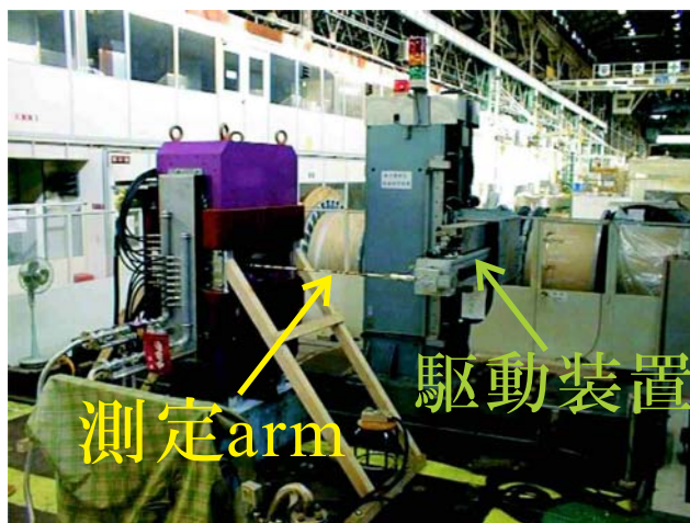
図 3.16: 三次元駆動装置を使った Q 測定時の様子
