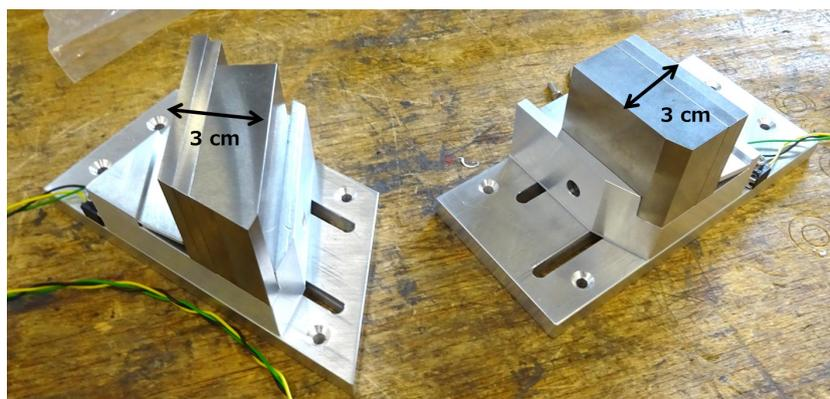
図 3.13: 製作した QF バックグラウンド吸収体の写真。左が Spek-A 側、右が Spek-C 側に設置される。
