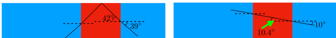
(c) 入射角 39^\circ のときの光の経路 (スペーサー:アクリル) (d) 入射角 10^\circ のときの光の経路 (スペーサー:アクリル)
