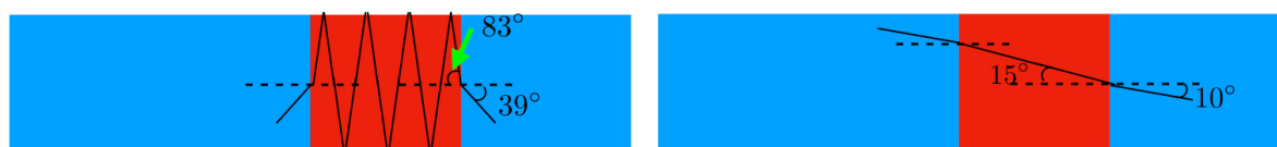
(a) 入射角 39^\circ のときの光の経路 (スペーサー:空気) (b) 入射角 10^\circ のときの光の経路 (スペーサー:空気)
