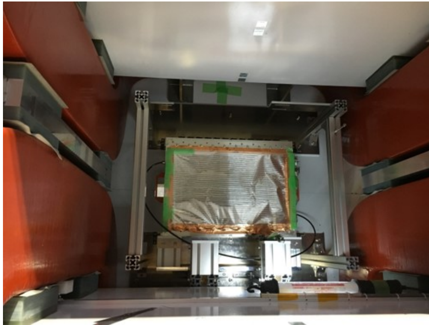
図 2.25: KURAMA マグネットの中から見た SDC1 の写真。奥に見える赤茶の銅テープで囲われた部分が SDC1 であり、両側に見える赤い部分が KURAMA マグネットのコイルである。
