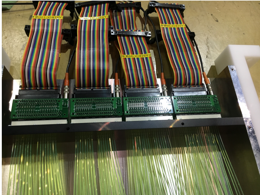
図 3.17: FHT に MPPC 基盤とケーブルを取り付けた様子。1 の MPPC 基盤に 16 個の MPPC が実装されている。
