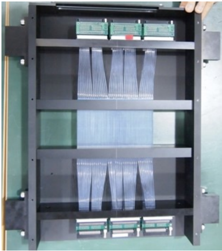
(a) ビーム用ファイバー飛跡検出器 BFT の写真。直径 1 mm のシンチレーティングファイバーが 1 層に 160 本並んでいる。
