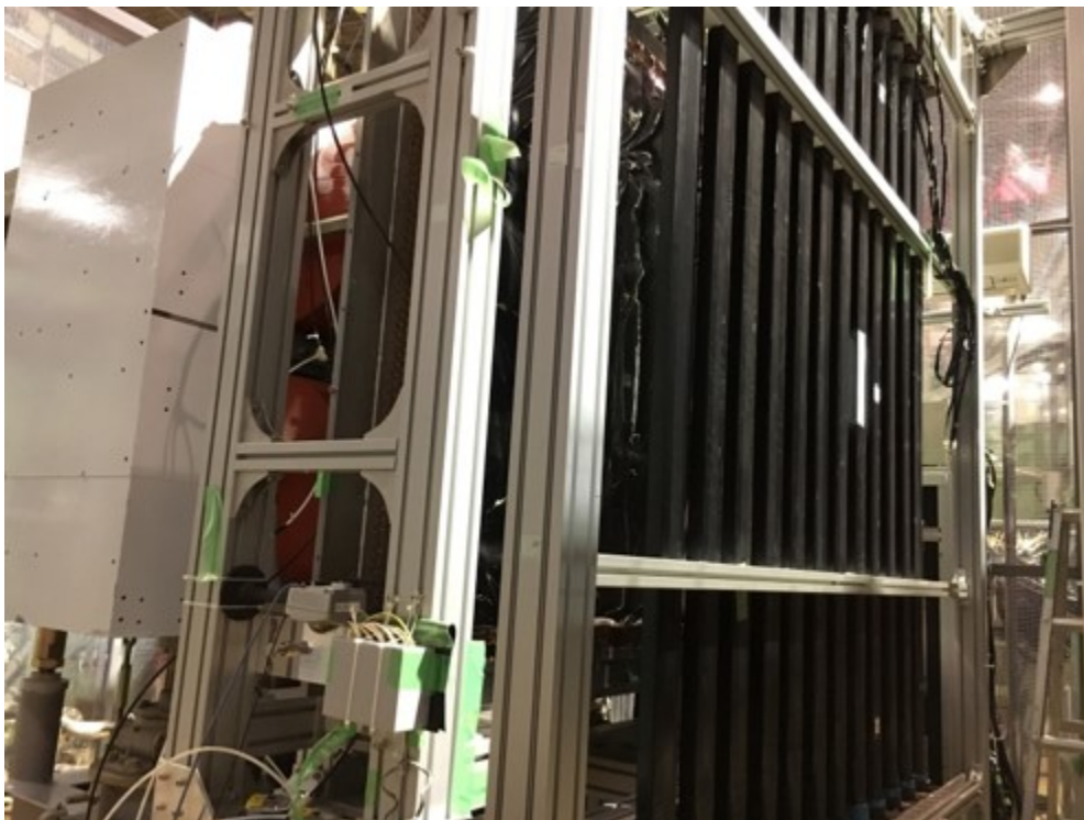
図 2.18: TOF カウンターの写真。ブラックシートで覆われている部分が TOF カウンターである。全 24 セグメントが 5 \text{ mm} のオーバーラップをもって並んでいる。
