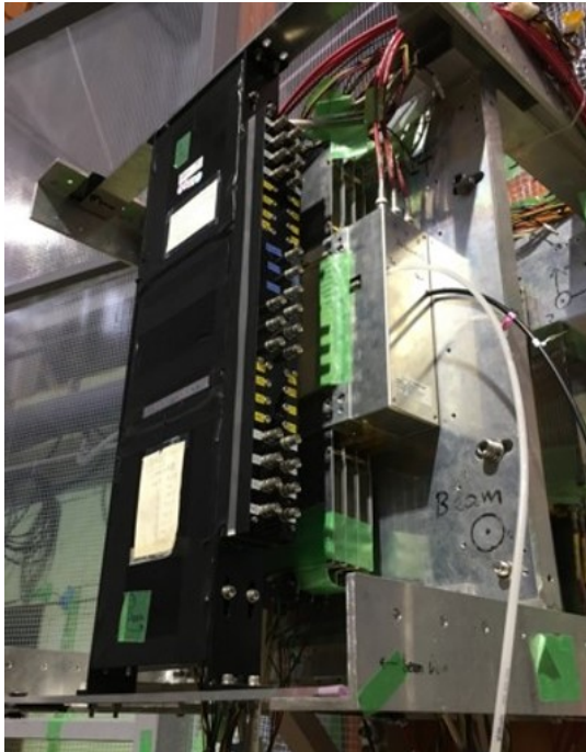
(a) ビームホドスコープ BH2 の写真。黒い筒体の真ん中部分が有感領域であり、BH1 と同様に上下に取り付けられた光電子増倍管により読み出す。
