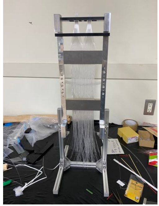
図 4.5: BFT-D X 層のファイバーを張り終 えた様子.
