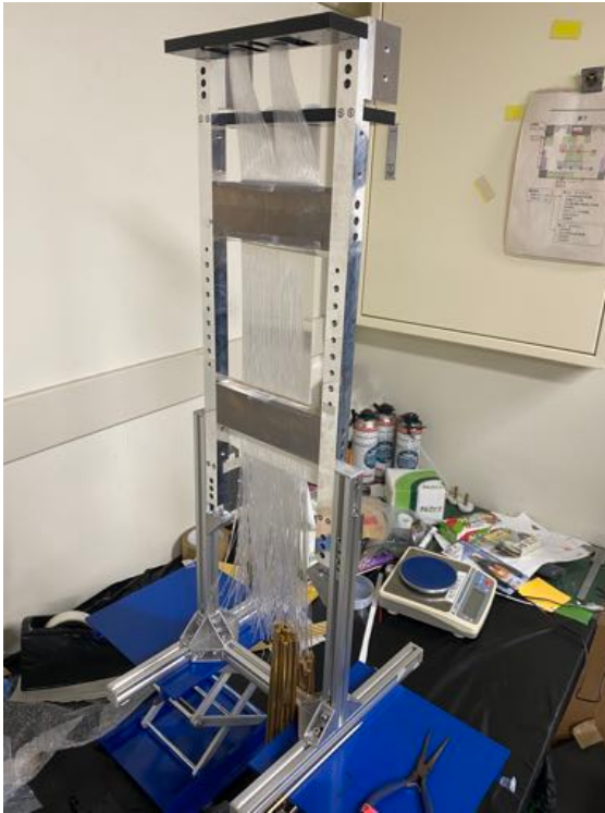
図 4.8: BFT-D X 層のファイバーを錘をかけたがら固定している様子。
