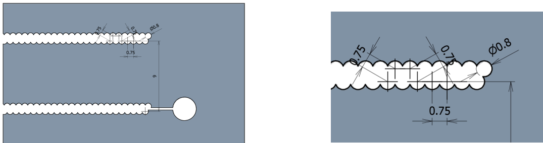
図 3.9: ファイバー固定用フレームの断面図とその拡大図。
