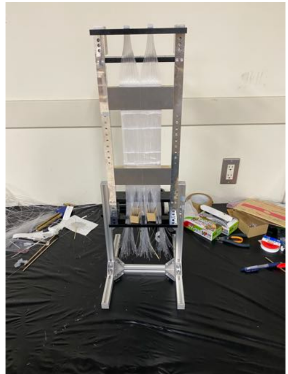
図 4.15: BFT-D X' 層のファイバーを固定した様子.
