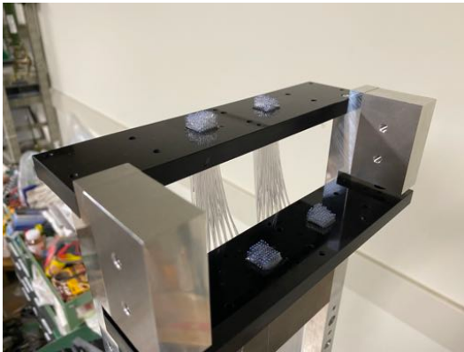
図 4.16: やすりがけ前の読み出し面の様子.
