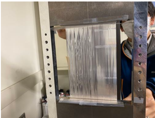
図 4.10: 一部のファイバーを固定した様子. 右側 1/3 程度が固定されたファイバーであり, 真っ直ぐ張られている。
