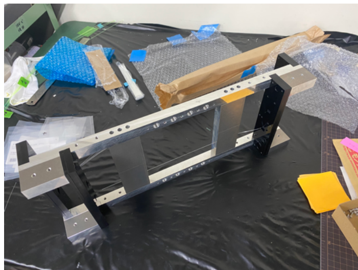
図4.1: BFT-Dのフレームを組み立てた様子。
