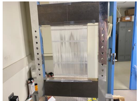
図 4.11: BFT-D X 層の全てのファイバーを固定した様子。
