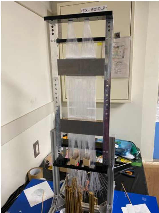
図 4.14: BFT-D X' 層のファイバーを錘を掛けながら固定している様子.
