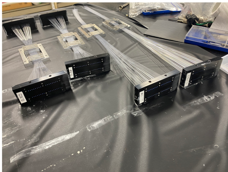
図 A.2: ファイバーテスト用検出器の写真. 4種類のシンチレーションファイバーを用いて製作した.
