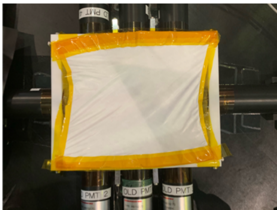
図 2.13: 実験後に確認されたエアロジェルの様子。(a) 表面のテフロンシートが端の領域において収縮していることが確認できる。(b) エアロジェル本体に多数の傷や気泡が見られ、劣化が進んでいることが分かる。
