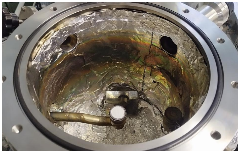
図 4.15 スパッタリングチェンバー内部
