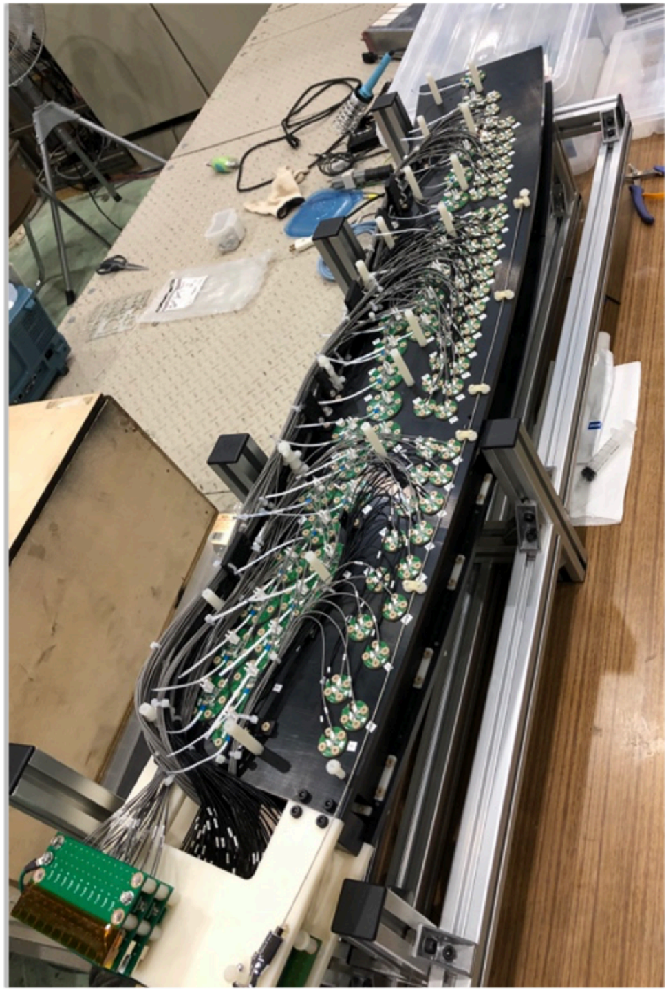
図 37: 作業中に撮影した写真。TagB のアンプと MPPC に電圧をかけるためのプリント基板が外されている。光子標識化装置は移動するとき及び作業時に装置を支えるためのアルミ・フレームに収められている。
