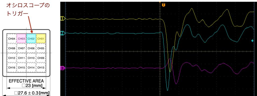
図 53: 実光子ビームによる MCP-PMT の波形
