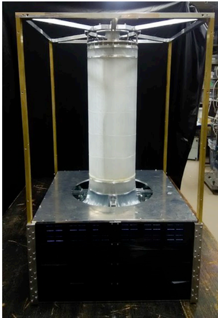
図 1.4: CFT の写真 [12]。写真下部の黒い部分には各ファイバーの端面が来ており、MPPC をネジ止めで取り付けられるようになっている。実験で使用する際には、写真の状態から 90 度回転した状態 (写真下部が上流側、写真上部が下流側になる) で設置される。
