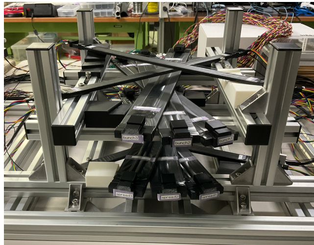
図 3.4: セットアップ A の案 1。試作検出器を 3 つ重ねたもの 2 つを、IH を 2 つ交差させたもの同士で挟んだもの。試作検出器を 3 つを、角度をつけて重ねているのは、ASD を取り詰める部分が干渉して余分に距離が離れることを防ぐため。
