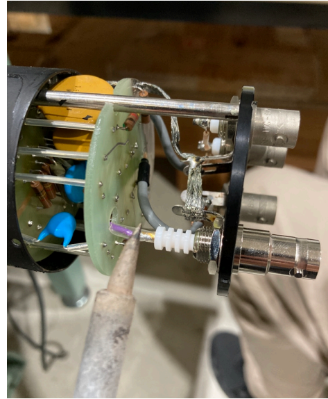
図 4.1: 左側の写真は交換した MHV コネクタ (左) と SHV コネクタ (右)。右側の写真は PMT の外筒を外して、コネクタを付け替え、ハンダ接合部を熱収縮チューブで絶縁しているときの様子。
