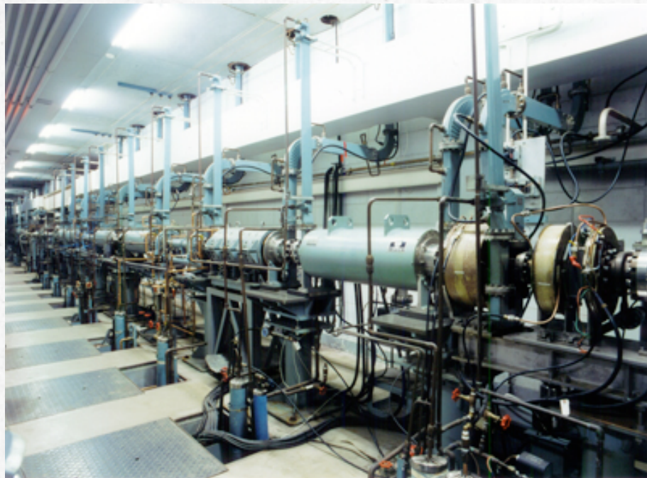
東北大学電子光物理学研究センター 300MeV 電子LINAC
